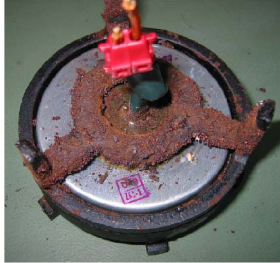
Figura 11-A: Corrosione sulla gabbia dell'accenditore del motore del razzo
