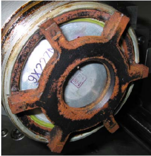
Figura 11-A: Corrosione sulla gabbia dell'accenditore del motore del razzo
