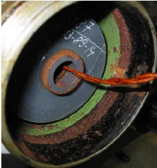
Figura 11-B: Corrosione all'interno dell'alloggiamento del motore del razzo
