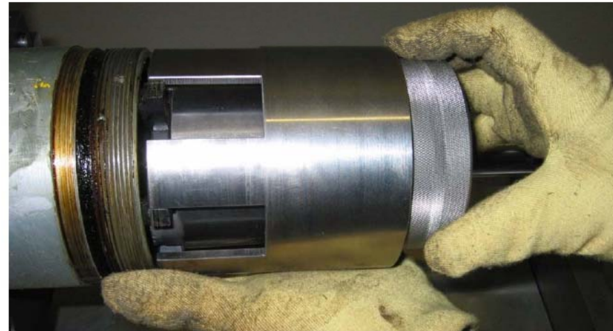
Figura 11-C: Special tool per smontaggio dell'accenditore del motore del razzo
